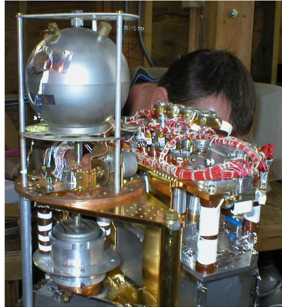
Figura 14. Il nuovo piano focale di *BOOMERanG*, sensibile alla polarizzazione della CMB. Sono visibili a sinistra il refrigeratore ad  $^3\text{He}$  e a destra il blocco dei rivelatori bolometrici, con le ottiche di piano focale ed i filtri che definiscono le bande di frequenza. Il piano focale viene inserito in un criostato ad elio superfluido, che lo raffredda a 1.6K. Il blocco dei rivelatori viene raffreddato a 0.3K per minimizzare il rumore dei rivelatori.
