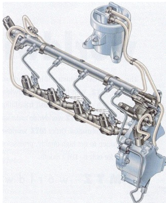
Figura 12. L'Apparato d'iniezione Common Rail della Bosch
