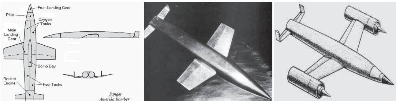
Fig. 8 - Il bombardiere di Sänger, disegno e modello per studi aerodinamici (internet)
