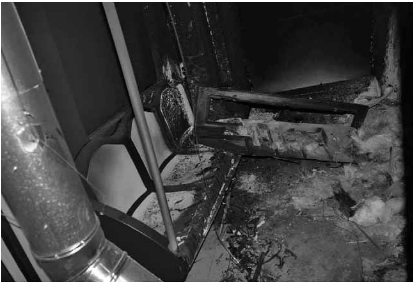
Fig. 7 - Cassa sacrificale – Sedili dopo la sperimentazione
