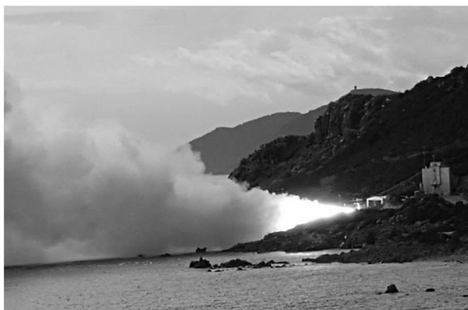
Fig.3. I primi test di fuoco al banco statico del P120, al banco verticale in Guyana Francese, e di Z40, al banco orizzontale presso il Poligono militare di Salto di Quirra.
