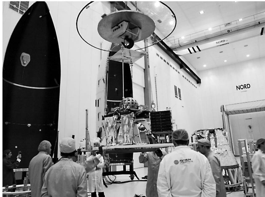
Fig. 2. Le fasi di integrazione del satellite LARES all'interno del fairing.
