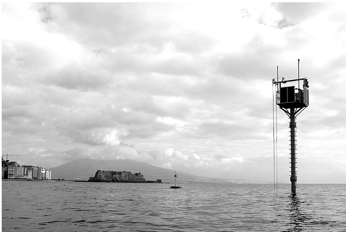
Fig. 1. Boa elastica (meda) situata nel Golfo di Napoli. Questa struttura misura diverse variabili ambientali in modalità semi-continua, automatica e da remoto ( www.szn.it ).
