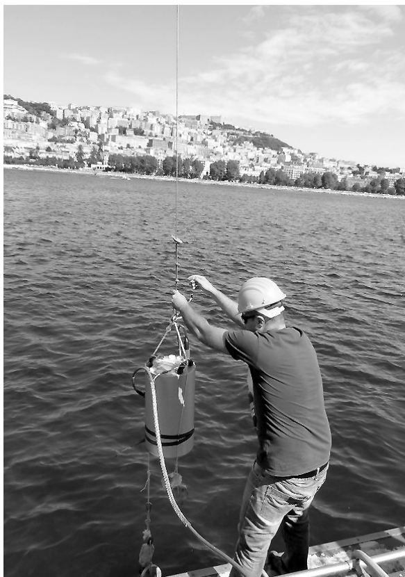
Fig. 2. Citometro a flusso immergibile che conta e misura proprietà ottiche del fitoplancton. Questo strumento funziona in continuo su boa, a bordo di navi e in laboratorio (www.cytobuoy.com).
