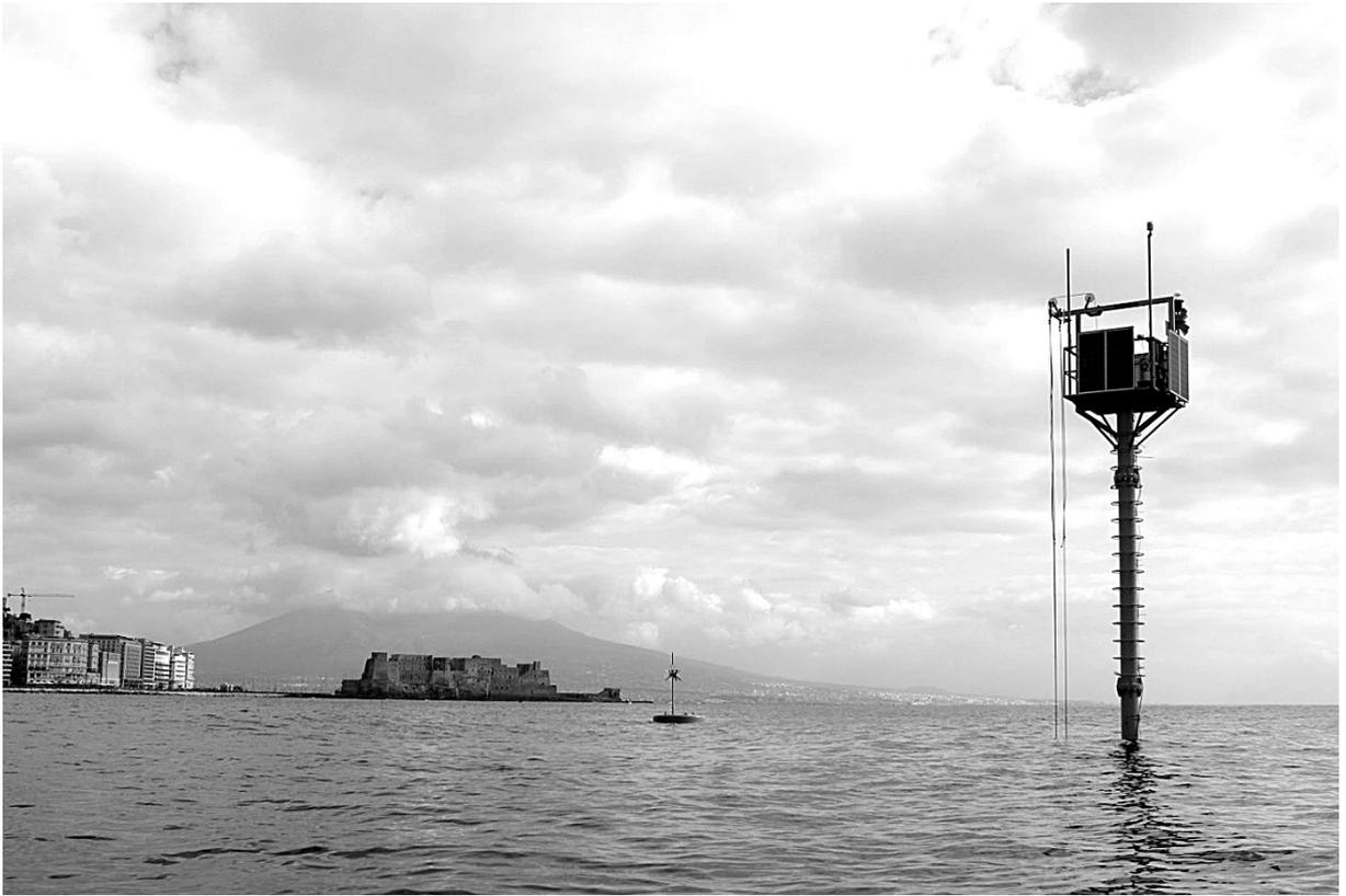
Fig. 1. Boa elastica (meda) situata nel Golfo di Napoli. Questa struttura misura diverse variabili ambientali in modalità semi-continua, automatica e da remoto ([www.szn.it](http://www.szn.it)).
