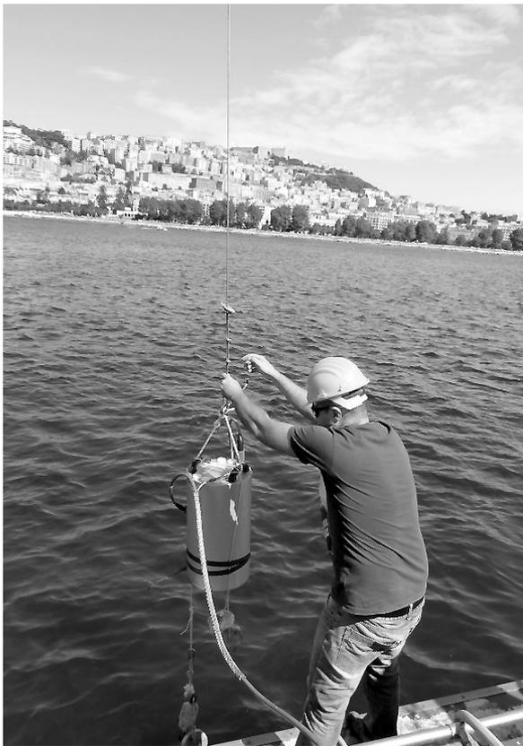
Fig. 2. Citometro a flusso immersibile che conta e misura proprietà ottiche del fitoplancton. Questo strumento funziona in continuo su boa, a bordo di navi e in laboratorio (www.cytobuoy.com).
